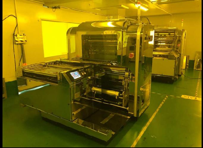
本装置は枚様にて投入されるCCLや銅張積層板の表裏両面に対し、感光性ドライフィルムレジストを基板長さに応じて、自動で額縁状にラミネートする装置です。
